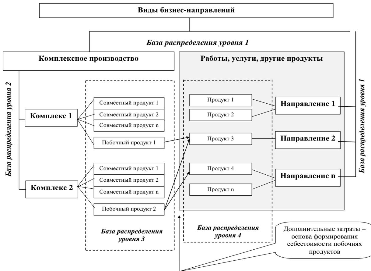
Рисунок 1. Схема уровней распределения затрат комплексного производства.
